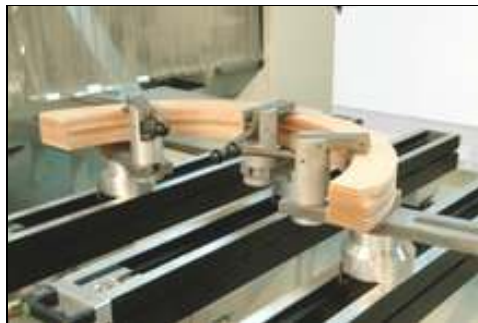
Innovatives Aufspannen der Werkstücke mit dem Traversen- Konsolensystem...
