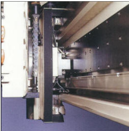
Gross dimensionierte Flachführungen in Verbindung mit Linearantrieb und Glasmassstab für besondere Bearbeitungsergebnisse. Optisches Messsystem (Glasmassstab) für Referenzwerte in Dynamik und Präzision.
